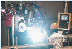
工作人员操控智能设备进行焊接,工业烟尘通过滤筒净化。
