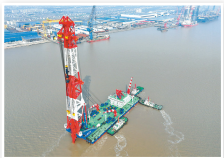
世界最大打桩船启航 赴杭州湾跨海铁路大桥施工
